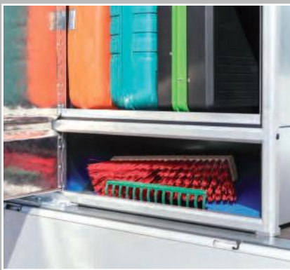
Versperrbarer Stauraum* für langstieliges Werkzeug, Zugriff und Beladung von beiden Fahrzeugseiten
