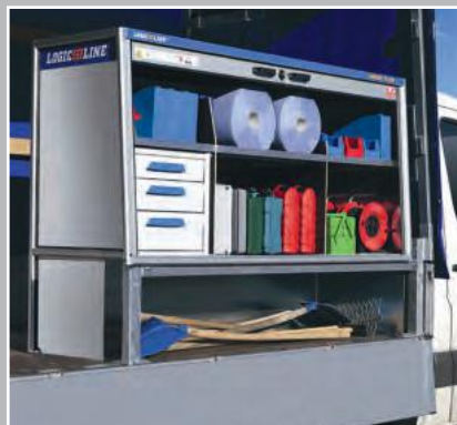
Zusätzlicher Stauraum durch Aufständerung auf Bordwandhöhe* und Abdeckbleche*
