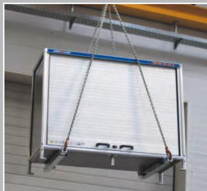
Durch Teleskop-System komfortabel zu bedienende Kranhebevorrichtung*
