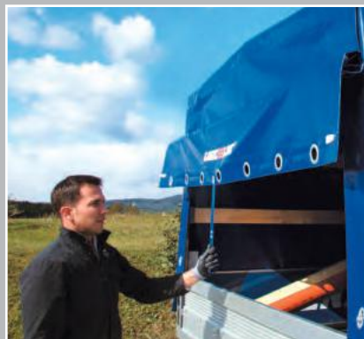
Planenlift (Federrollo)* hinten für schnellen Zugriff auf die Ladefläche
