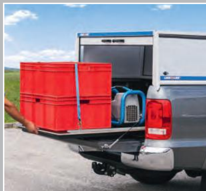
Einfache Be-/Entladung von schweren Lasten bis 250 kg mit Schwerlastauszug* (Seite 40)
