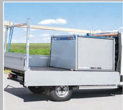
HeckRack HR-200 kombiniert mit FrontRack Adapter auf werkseitigem Fahrerhausschutz und RoadBox
