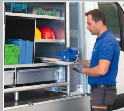
Schraubstock integriert in ToolBox TB-150 XL
