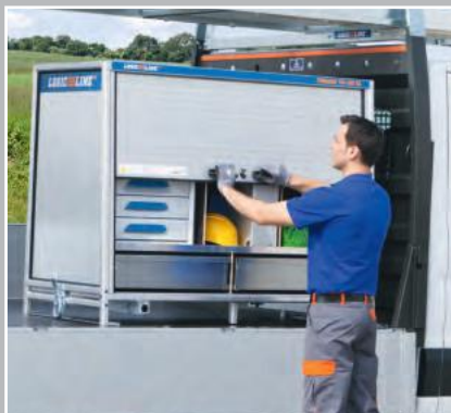
Komfortabler Zugriff von Fahrzeugseite durch Aluminium-Rollltür
