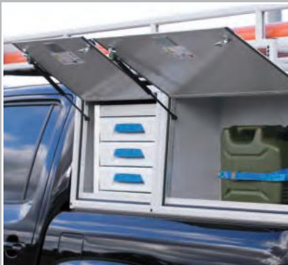
Ladencontainer* für Kleinmaterial, Seitenbox Hardtop* mit Alu-Zurrschiene*
