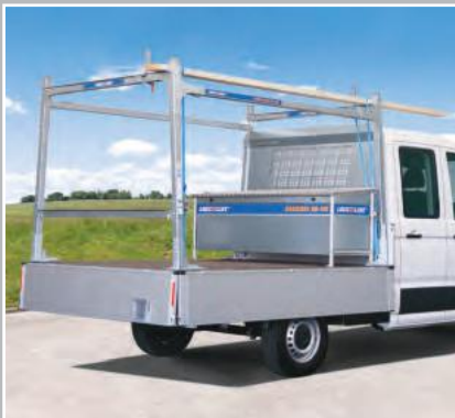
Optimale Ausnutzung der Ladefläche durch horizontalen Transport von Langgut
