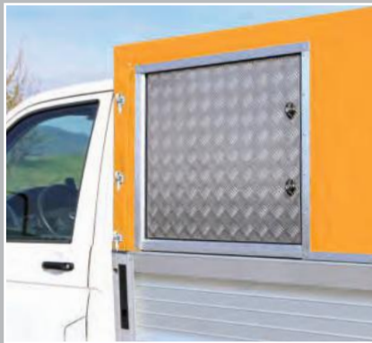
Stauraum über die gesamte Fahrzeugbreite in RoadBox RB-75 CV, Türen an beiden Seiten
