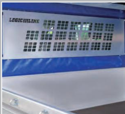
Heckscheibenschutz* hemmt das Eindringen von Ladung in die Fahrerkabine
