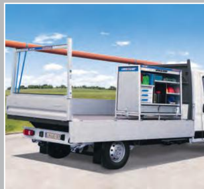
HeckRack HR-200 kombiniert mit werkseitigem Fahrerhausschutz und ToolBox
