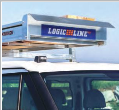
Integriertes Formschlussblech vorne verhindert Rutschen der Ladung
