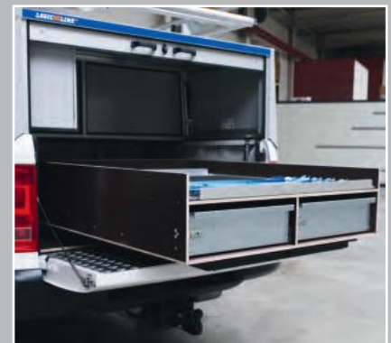
Doppelte Nutzfläche und komfortabler Zugriff durch integrierte Auszugsladen*
