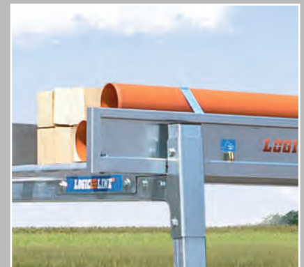
Geprüfte Zurrpunkte im Langgutträger
