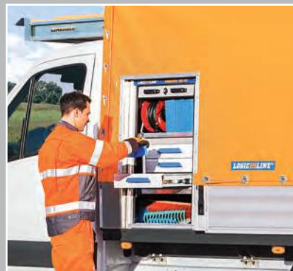
Komfortabler Zugriff von beiden Fahrzeugseiten mit Alu-Rolltür, Ladencontainer* für optimale Sortierung
