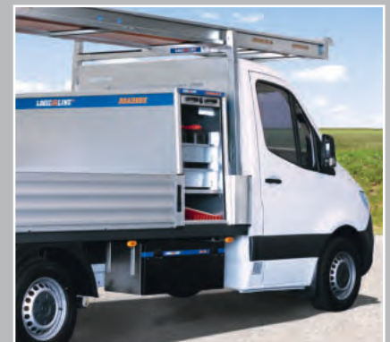
Optimale Integration der RB-70 in gekürzte Pritschenbordwand
