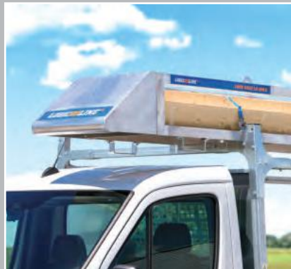
LongRack schützt Langgut durch Käfigbauweise. Formschlussblech mit Spoiler* ermöglicht effiziente Ladungssicherung
