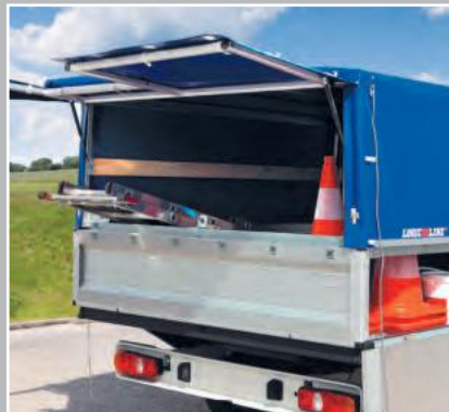
Heckklappe* für komfortables Öffnen und Schließen der Plane
