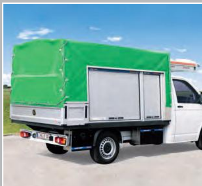
Langgutträger innerhalb der Plane bei CombiCover
