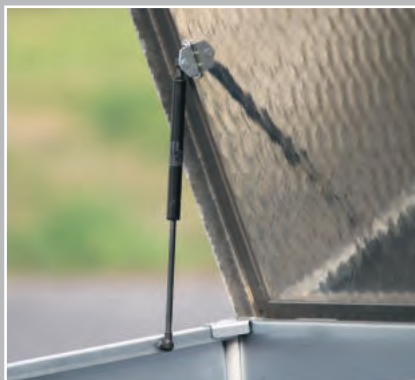
Komfortable Gasfeder für selbsttätige Öffnung und Fixierung (Standard bei BasicBox, optional bei EcoBox)
