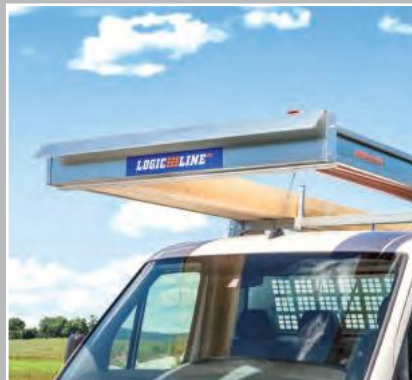
PowerRack mit Frontausleger* für horizontalen Transport von schwerem Langgut bis 6 m Länge
