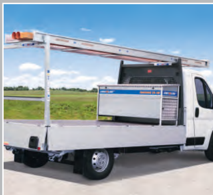
CombiRack kombiniert mit werkseitigem Fahrerhausschutz und CombiBox
