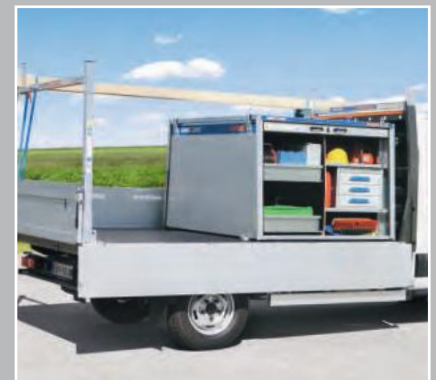
RB-150 in Kombination mit FrontRack Adapter und HeckRack für horizontalen Langguttransport
