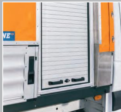
Optimale Integration in gekürzte Pritschenbordwand und Plane
