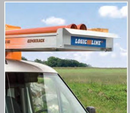
Integriertes Formschlussblech vorne verhindert Rutschen der Ladung
