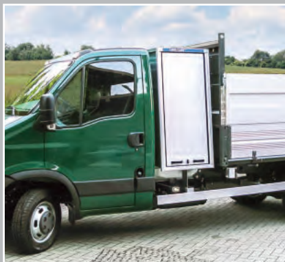
Montage auch zwischen Fahrerkabine und Kipperaufbau möglich
