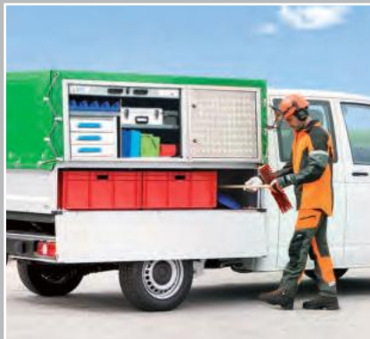
Stauraum unterhalb der Boxen, auch für langstieliges Werkzeug – Öffnung der Bordwand ohne Aufplanen durch Planenfixierung*
