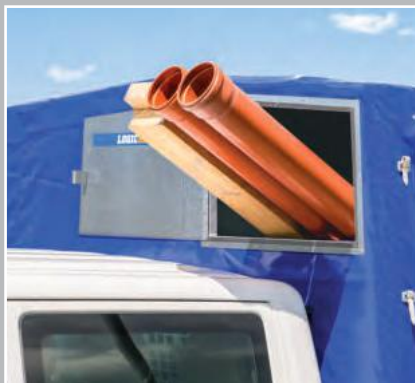
Ladeklappe* für komfortables Öffnen und Schließen der Beladeöffnung von innen
