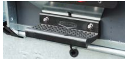
SICHERER AUFTRITT durch den Auftritt an der Hinterklappe
